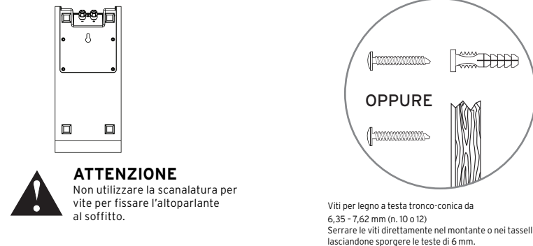
FIGURA 4 FISSAGGIO A PARETE DEGLI ALTOPARLANTI SURROUND
